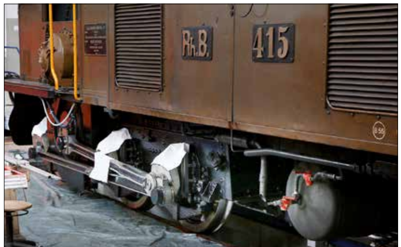
rechts: Kurz vor der Fertigstellung: Auch das Krokodil 415 bekam eine umfangreiche Revision.
